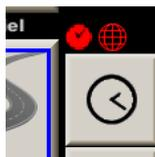
Celui de gauche indique que l'horloge est décalée par rapport à l'heure officielle. Elle n'est plus synchronisée parfaitement sur l'horloge du GPS. Elle suit l'horloge du GPS avec un décalage constant et extrêmement précis.
