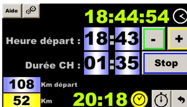
Le principe est d'entrer l'heure de départ et la durée pour que l'appareil calcule l'heure de pointage. Si on entre la distance entre les deux CH, il pourra aussi calculer la moyenne à tenir jusqu'à l'arrivée et l'avance ou le retard.
